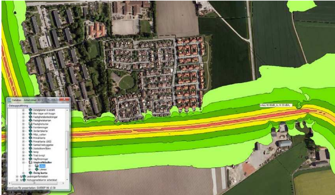
Fig. 5 Bilden visar utbredningen av den ekvivalenta ljudnivån utmed Östergatan i 5 dB "ekvidistanser" dvs varje färgfält från centrum av Östergatan och utåt (norrut resp söderut) har 5 dBA lägre ekvivalent (medelvärdes) nivå. Det översta ljusgröna fältet representerar 45 dBA ekvivalentnivå. Bilden gäller dagens situation utan eventuell framtida skärmning av buller.
